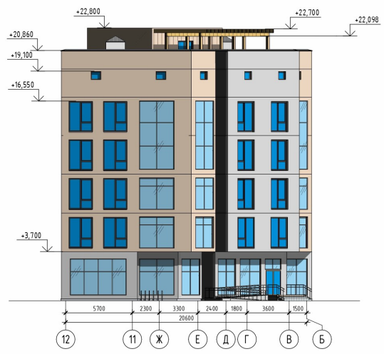
Фасад в осях 12 - Б М 1:200
